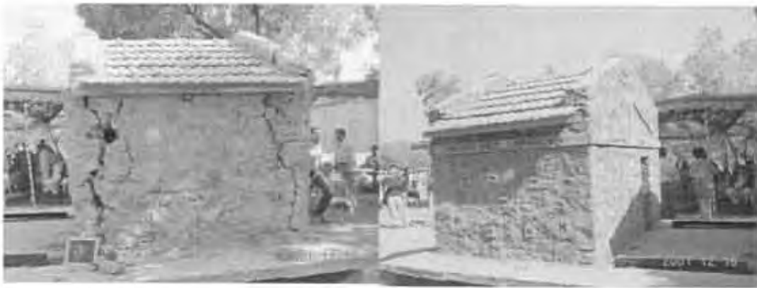
9 回目の振動による被害 (左は耐震補強なし、右は耐震補強あり) (P5-18)
