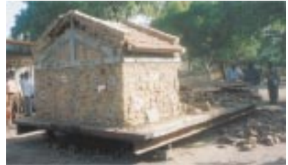
実験後の模型家屋(手前が改修作業を施したもの)
